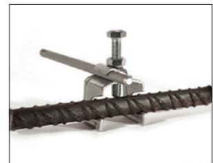
Fundamente der sind durch Schraub- und Klemmverbindungen z. B. Verbindungsklemmen für Gebäude-Armierungen in Abständen von 2 m dauerhaft elektrisch leitend und mechanisch fest zu verbinden, Rödeldrahtverbindungen sind nicht zulässig.
