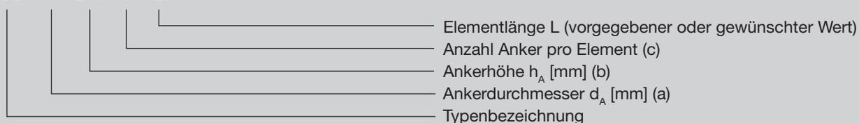
Bei Sonderelementen ist im Auftragsfall die Maßkette anzugeben.
